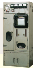
●大気汚染自動測定連続記録計 国産第一号機
